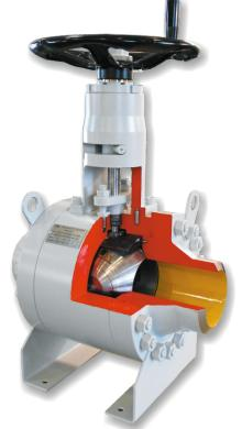
высокие температуры или, по желанию, из эластомера. Исполнение с выдвижным штоком и невыдвижным маховиком. Специальная конструкция затвора гарантирует двухстороннее герметичное закрытие и требует небольшого вращающего момента. Во время работы между полушариями затвора не возникает трения. Происходит безтурбулентное протекание среды с минимальными потерями. Вентили могут устанавливаться в обоих направлениях потока среды.
